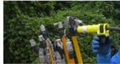
②被覆を剥ぎ取った縁回し線に、端末キャップを取り付ける。
